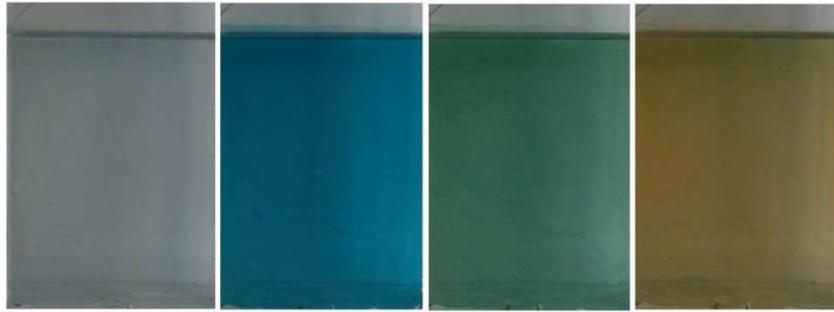
Abb. 8: Von links nach rechts: weißes  $K_2Fe^{II}[Fe^{II}(CN)_6]$ ; blaues  $KFe^{II}[Fe^{III}(CN)_6]$ ; grünes  $K[Fe^{III}_3\{Fe^{III}(CN)_6\}_2\{Fe^{II}(CN)_6\}]$  und braunes  $[Fe^{III}Fe^{III}(CN)_6]$  auf FTO-Glas.
