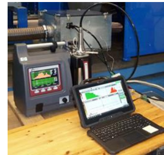
Abb.2: Sammlung der UFP mittels Impaktor ELPI+
