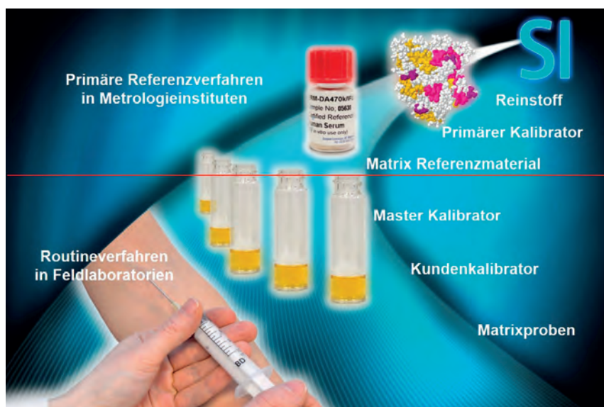
Rückführungskette für Messungen in Routinelaboratorien auf Reinstoffe und damit auf das Internationale Einheitensystem (SI). Der rote Strich trennt Verantwortungsbereich der Metrologieinstitute von dem der Laboratorien. (Abbildungen: PTB)
