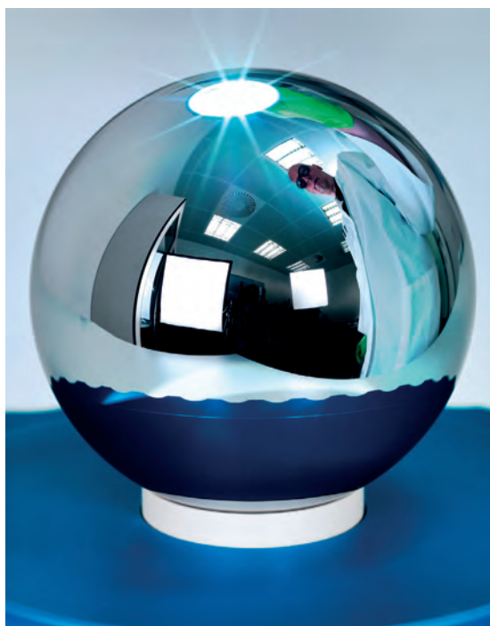
Höchstpräzise Si-Einkristallkugel zur Neubestimmung der Avogadro-Konstante
